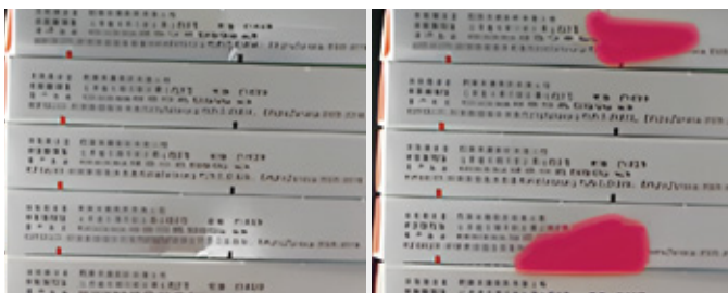
药品包装盒破损缺陷检测
